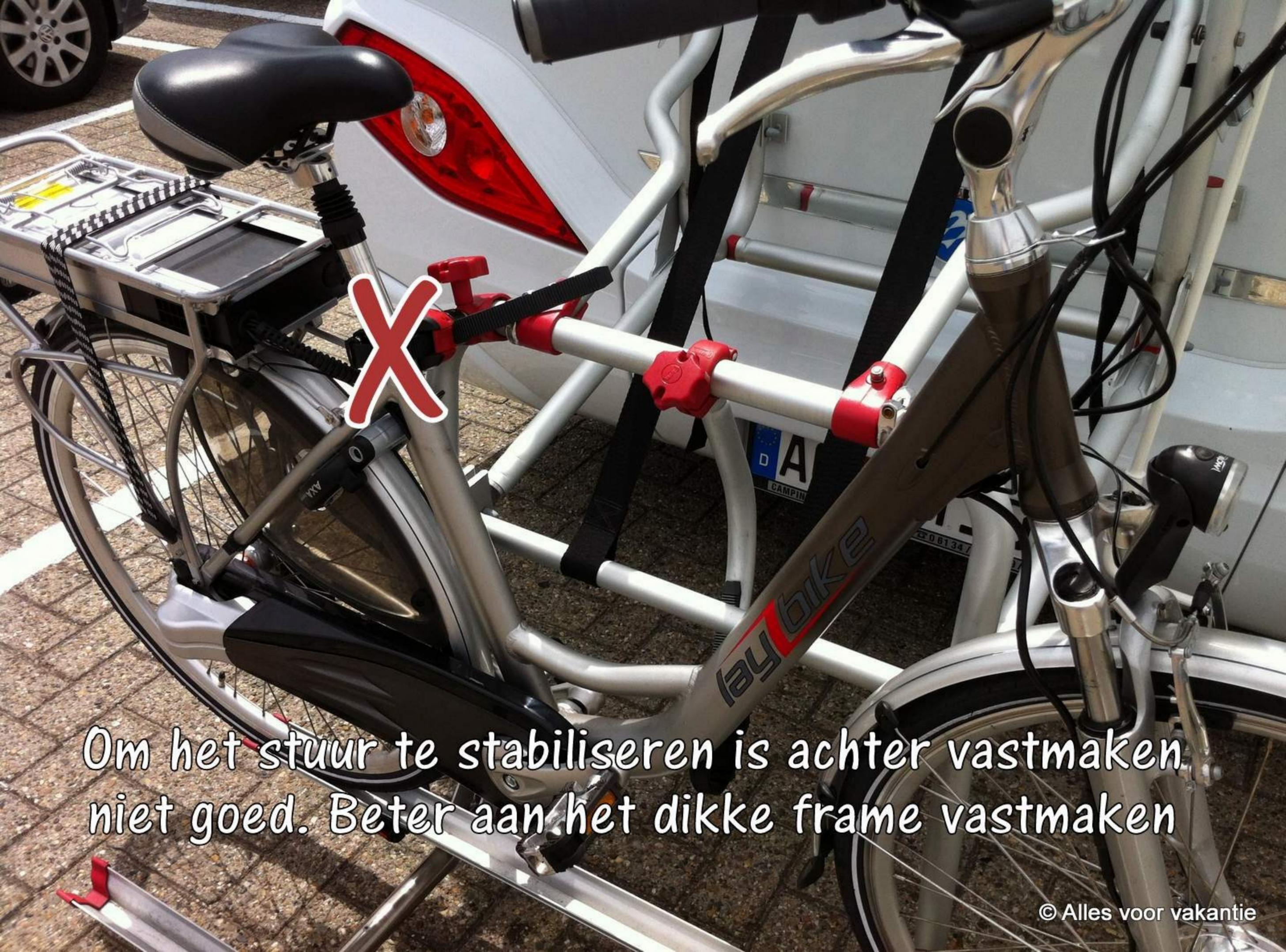
Om het stuur te stabiliseren is achter vastmaken niet goed. Beter aan het dikke frame vastmaken
